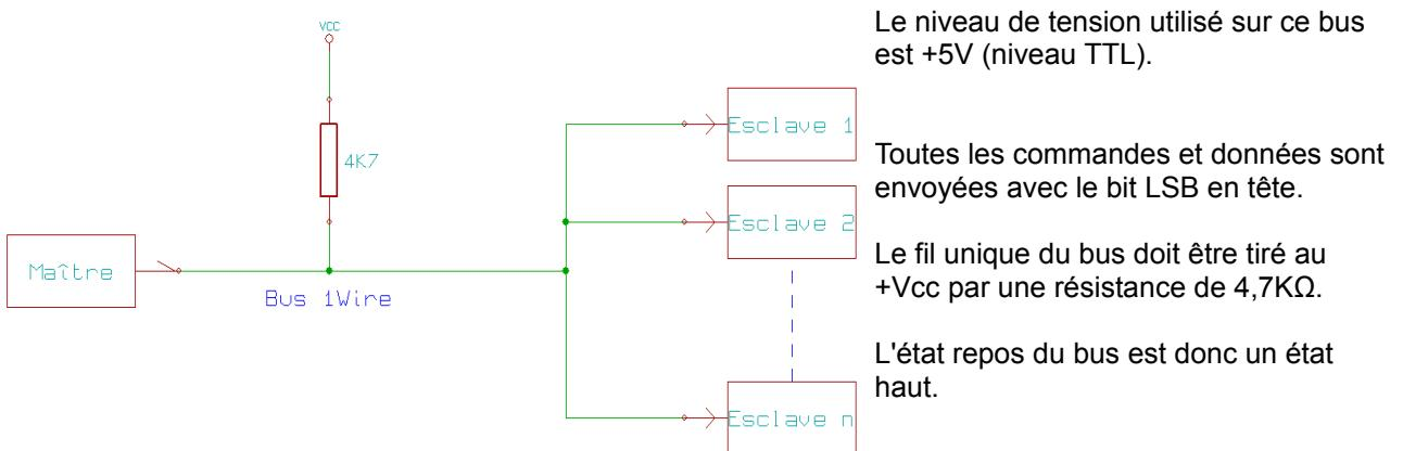
L'avantage de ce bus est qu'il peut être utilisé en mode "parasite" (alimentation à partir du fil de données). Cela permet d'utiliser seulement 2 fils (et non un seul comme le nom le laisse supposer), un fil de données et un fil de masse.
