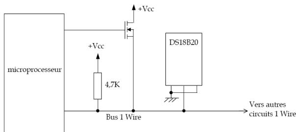
Quand le bus 1Wire est à l'état haut, une capacité interne se charge et sert de réservoir pour alimenter le circuit quand le bus est à l'état bas. Dans ce cas la broche Vcc du circuit est raccordée à la masse.
