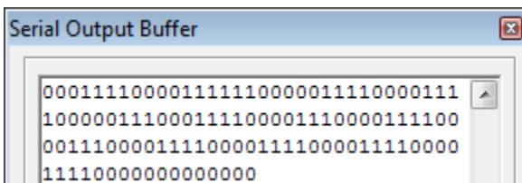
En cliquant environ une fois par seconde, ce petit test permet également de mesurer la vitesse du simulateur : on voit que la boucle tourne 4 ou 5 fois chaque seconde.
