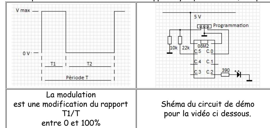
Ici, c'est un 08M2, le plus petit des picaxes, il était déjà sur la platine d'essais. Il n'y a qu'une sortie compatible avec la commande PWM, la broche C.2. Chaque picaxe a une ou plusieurs broches compatibles (voir doc).
