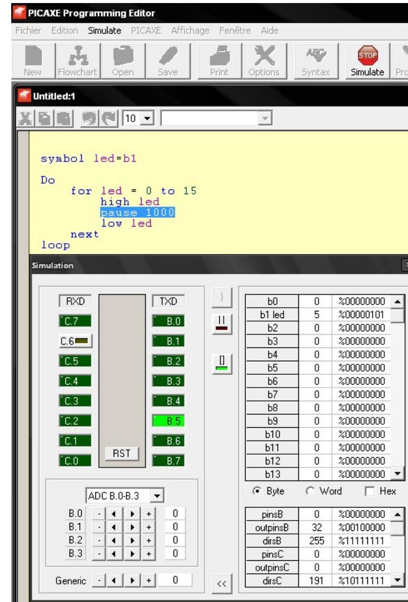
Une boucle For / next incrémenté le compteur "led" de 0 à 15, allume chaque broche pendant une seconde, jusqu'à la dernière, et le cycle recommence.
