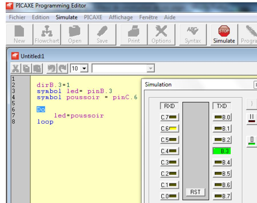
Le "if then" a disparu et il n'y a plus qu'une seule ligne, la diode en B.3 s'allume si on appuie sur le poussoir en C.6
